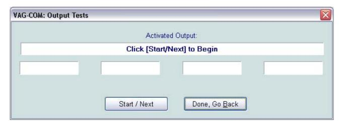
Se dovesse comparire la scritta "Requirements for Output Test not met" significa che uno dei requisiti precedentemente elencati non è stato rispettato, oppure che non è stata terminata un'operazione precedente. Per terminare
