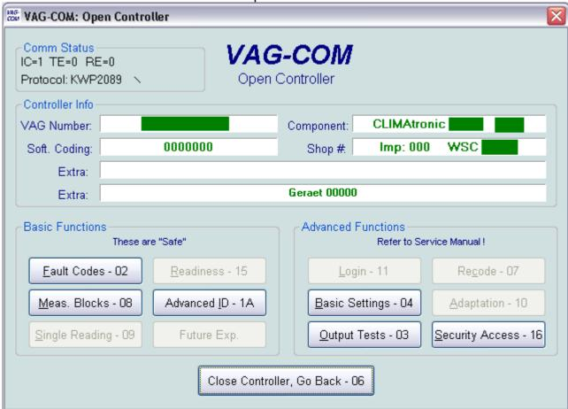
Tramite questo modulo è possibile verificare e, parzialmente, tarare le funzionalità del sistema di climatizzazione (climatizzatore, ventole, sensori, motoposizionatori e centraline). La descrizione di seguito si riferisce ai modelli dotati di Climatronic.
