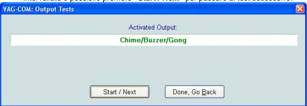
Inizia il test dell'indicazione acustica di allarme: se si sente un bip continuo è possibile premere "Start / Next" per terminare la procedura.
