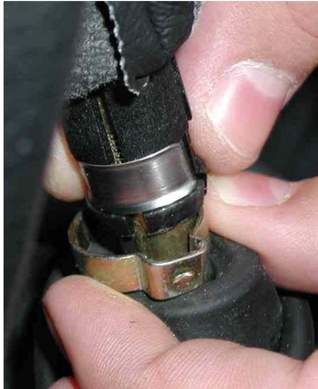
dettaglio del mezzo anello che tiene il pomello (in grigio)
