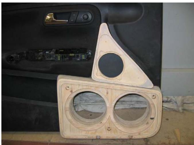
**Figura 23 - Supporto per medio assemblato**
