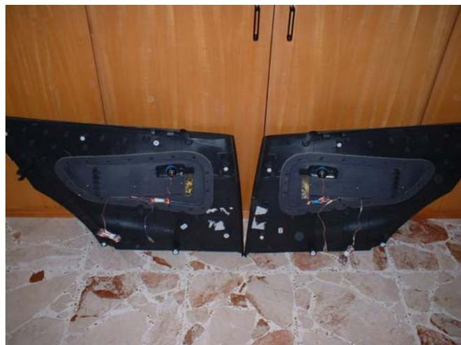
PRATICARE I FORI CON IL TRAPANO A SECONDA DELLE DIMENZIONI DELLE CASSE FACENDO ATTENZIONE CHE L' ALTOPARLANTE COINCIDA CON LA GRIGLIA FORATA DEL PANNELLO.
