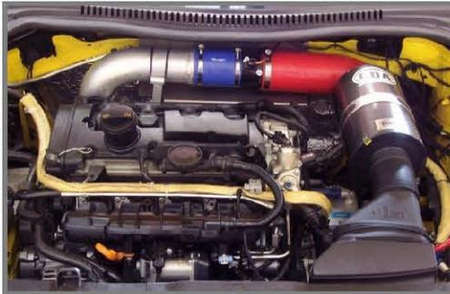
Il **motore** della Mk2 deriva direttamente dalla famiglia di motori VW 2.0 lt turbo di nuova generazione, 4 cilindri in linea con 4 valvole per cilindro ad iniezione diretta e capace di erogare ben 301 Cv a 6500 giri. Generosa anche la coppia, che sfiora i 340Nm a 4400 giri, ma gran parte della quale è già disponibile fin dai 2500 giri.
